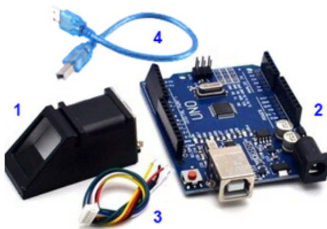
Рис. 3 – Сканер отпечатков пальцев: 1 – FPM10A оптический сканер отпечатков пальцев; 2 – Arduino UNO; 3 – провода для подключение сканера к Arduino; 4 – USB кабель для Arduino
